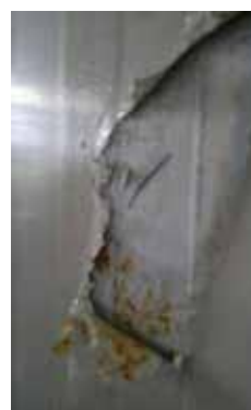
Ejemplo de oxidación después de la formación de ampollas
