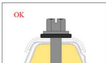
Figura 26: Aplicación de Fuerza suficiente al Tornillo
